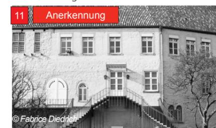
wurde die Baufälligkeit der Anlage festgestellt und in Absprache mit den zuständigen Denkmalbehörden die Abtragung der Treppenanlage beschlossen. Aufgrund der geringen Tragfähigkeit des Baugrundes wurde die Ausführung der neuen Treppe in Stahl, als zeitgenössische Konstruktion, beschlossen.
