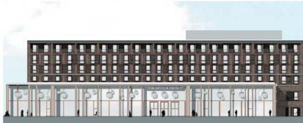
Mit Kolonnaden im vorderen Bereich: Diese Ansicht zeigt deutlich die über zwei Geschosse gehenden Säulen. Im Hotel-Teil sind die vier Einzelgeschosse erkennbar.
